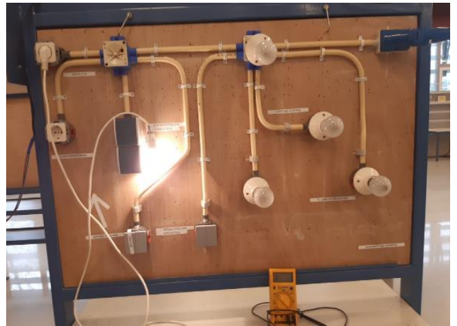
Figuur 70 Met de 2e serieschakelaar wordt de ventilatie geschakeld.
