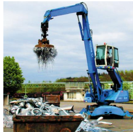
Figuur 15 Elektromagneet om staal uit afval te scheiden
