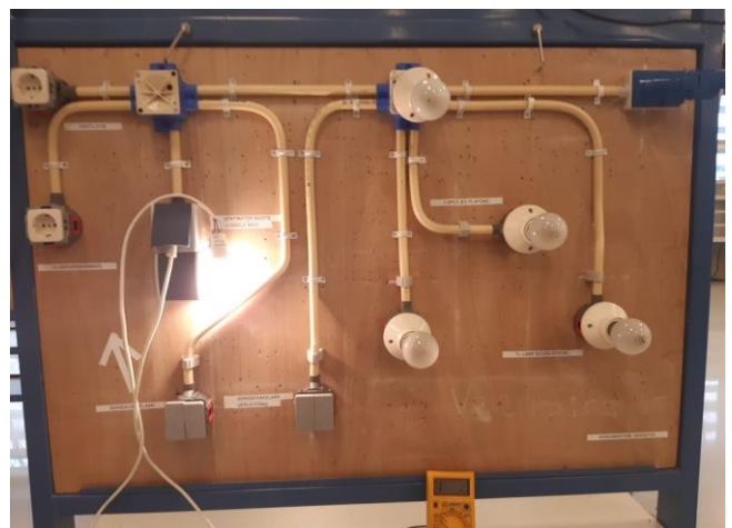
Figuur 72 Over de dubbele spatwaterdichte WCD staat te allen tijde spanning.
