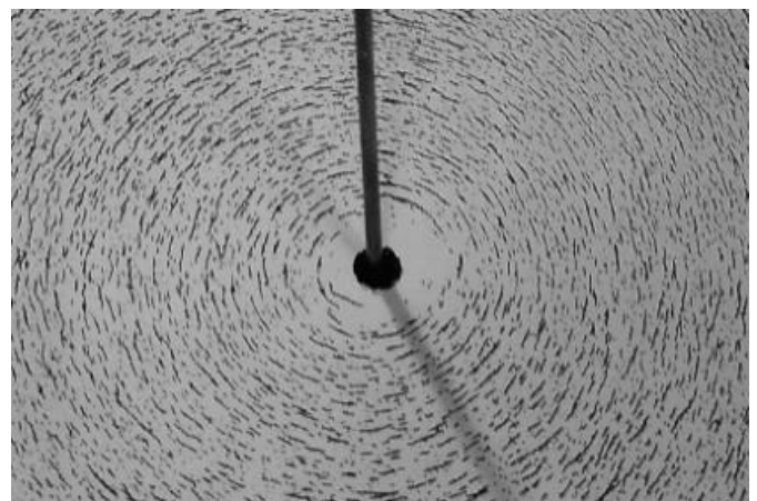
Figuur 9 Magneetveld van een stroomdraad
